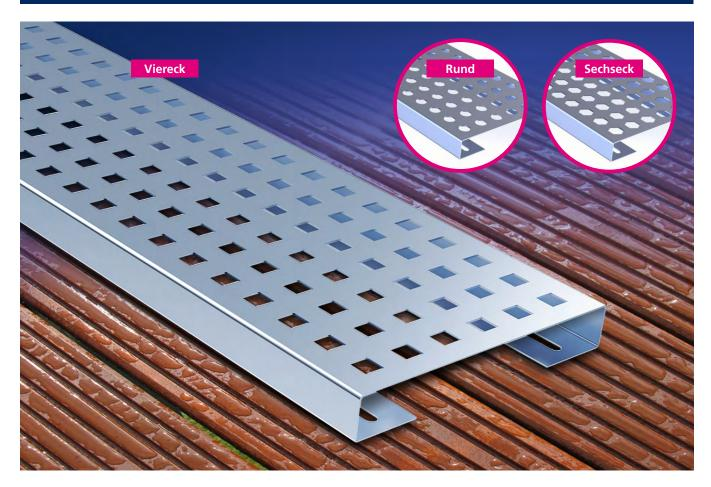
Die → Bangkirai-Fix-Rinnen von Polybit sind die derzeit sicherlich smarteste Lösung für die Entwässerung von Holzterrassen. Ohne weiteres Grundelement werden die einteiligen Roste direkt durch die Lochstanzung hindurch auf die Unterkonstruktion geschraubt.
